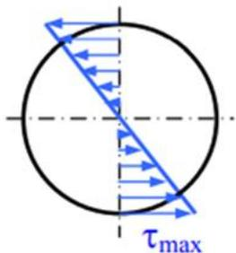
Закон распределения касательных напряжений – линейный.
