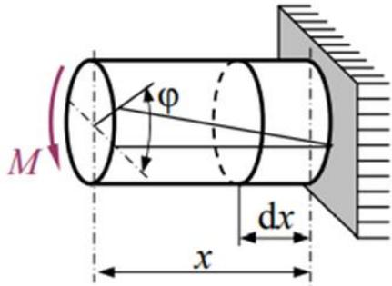
Левый торец бруса длиной  $x$  под действием внешнего скручивающего момента  $M$  повернется на угол  $\varphi$
